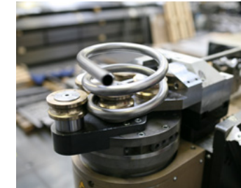
BIEGEN VON STAHLPROFILIEN
