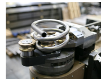
GIĘCIE PROFILI STAŁOWYCH
